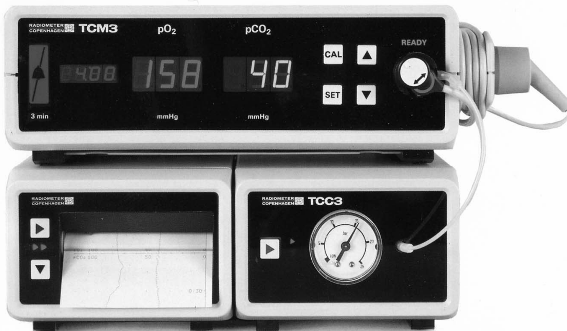
Abb.3: RADIOMETER™ -Überwachungssystem mit TCC3 ® mit TCM3 ® -Monitor
